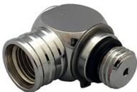
An der 1. Stufe drehbarer 90° Winkel aus Messing, Einbau zwischen HP-Schlauch und erster Stufe. Gedreht wird der gesamte Adapter, gut geeignet für enge Schlauchführungen zum Beispiel an Rebreathern.
